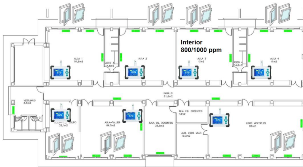
Figura 6. Apertura de ventanas. Medidor de CO 2 en cada aula.
